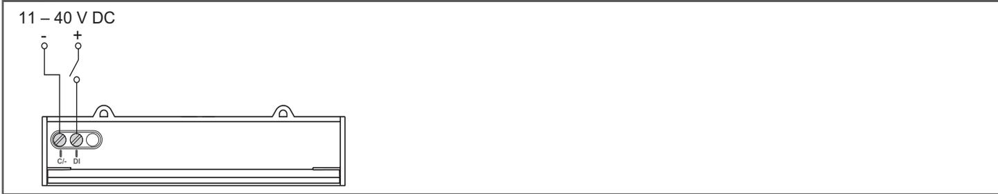
**Digital output / Salida digital / Sortie logique / Digitalausgang / Uscita digitale / Saída digital / Цифровой вывод / 数字输出**
